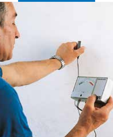
Kontroll av putsens fukthalt
